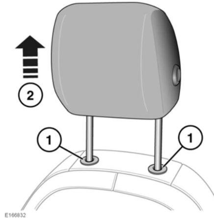
Pour déposer l'appuie-tête, le lever jusqu'à sa position maximale.
