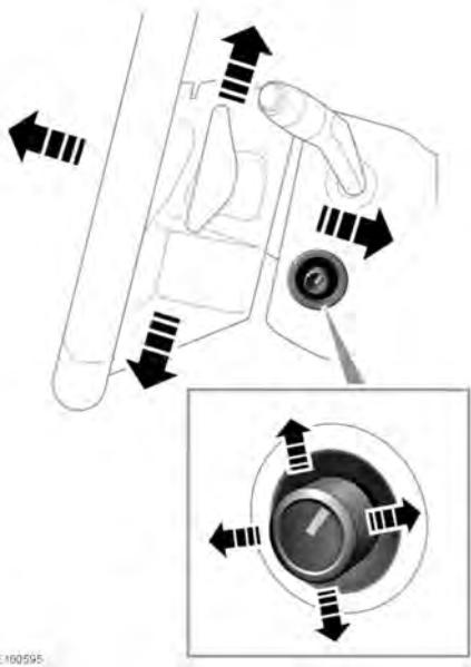
Les véhicules équipés d'une colonne de direction électrique peuvent être réglés pour modifier l'inclinaison et la profondeur du volant :
