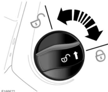
Les véhicules équipés d'une colonne de direction manuelle peuvent être réglés pour modifier l'inclinaison et la profondeur du volant :
