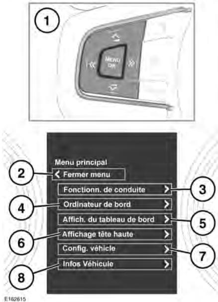
Vous pouvez configurer plusieurs fonctions du véhicule et paramètres d'affichage dans les menus du panneau d'instruments.
