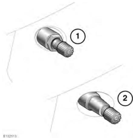
Les roues équipées d'un TPMS sont facilement reconnaissables à leur valve et leur contre-écrou métallique extérieur (1). Toutes les roues Jaguar sans TPMS sont dotées d'une valve en caoutchouc (2).
