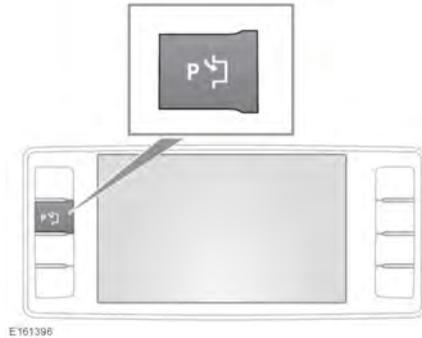
Une brève pression sur le bouton d'aide au stationnement permet d'activer le système. Le témoin LED situé sur le bouton d'aide au stationnement s'allume.
