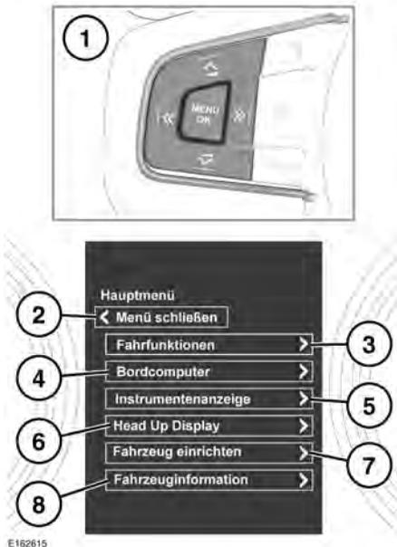
Eine Reihe von Fahrzeugfunktionen und Displayeinstellungen können über das Instrumententafel-Menü konfiguriert werden.
