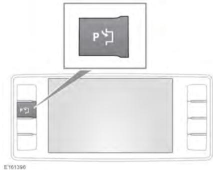
Durch kurzes Drücken der Einparkassistent-Taste wird das System eingeschaltet. Die LED-Anzeigeleuchte in der Einparkassistent-Taste leuchtet auf.
