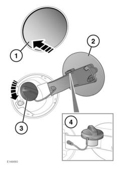
Die Tankklappe kann erst geöffnet werden, nachdem das Fahrzeug mit dem Smart Key entriegelt wurde.
