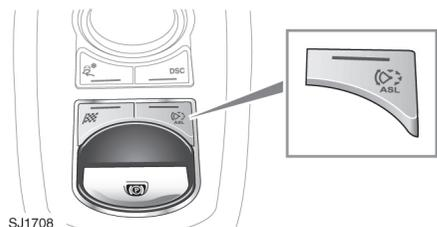
Über die **ASL**-Taste kann der Fahrer zwischen Geschwindigkeitsregelung und automatischem Geschwindigkeitsbegrenzer wählen. ASL kann auf eine Geschwindigkeit zwischen 30 km/h (18 mph) und 240 km/h (150 mph) eingestellt werden.
