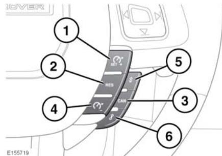
1. Pulse para configurar la velocidad actual del vehículo como la velocidad programada. El testigo del ACC se iluminará para confirmar que el sistema está en funcionamiento. Consulte **52. SISTEMA DE CONTROL DE VELOCIDAD (VERDE)**. Cuando el sistema ACC está activado, cada vez que se pulse el botón se aumentará la velocidad programada por encima de la velocidad actual del vehículo. La velocidad del vehículo aumentará gradualmente para alcanzar la nueva velocidad programada.
