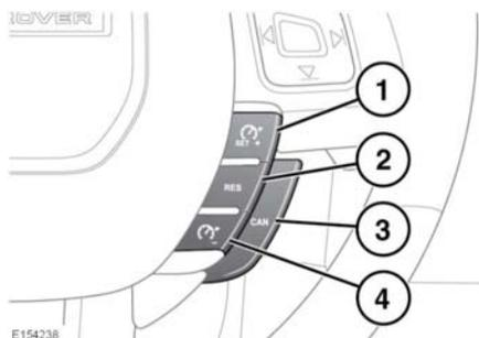
1. **SET+:** Pulse para programar la velocidad o aumentar la velocidad programada. El testigo del sistema de control de velocidad se ilumina para confirmar que el sistema está en funcionamiento. Consulte **52, SISTEMA DE CONTROL DE VELOCIDAD (VERDE)**.
