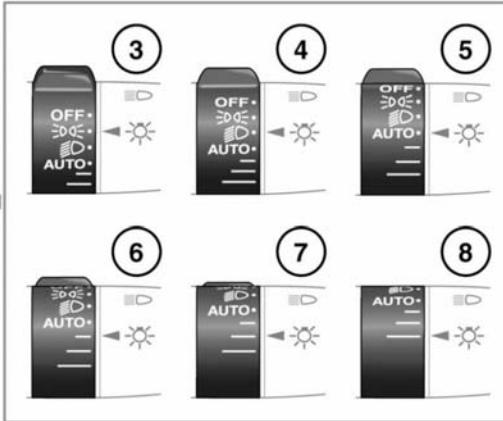
5. Faros automáticos. Con el contacto activado, si la luz ambiental disminuye se encienden automáticamente las luces de posición y los faros. Si la luz ambiental aumenta, las luces de posición y faros se apagan automáticamente.
