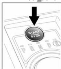
Con el pedal de freno pisado (1) y una llave inteligente Jaguar válida en el interior del vehículo, pulse brevemente el botón START/STOP (arranque/parada del motor). El motor se pondrá en marcha, el selector JaguarDrive se elevará desde la consola central y se podrá seleccionar la marcha.
