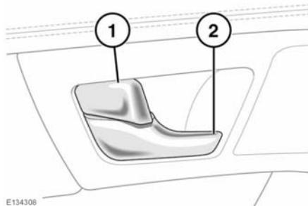
1. Presione la palanca de bloqueo para bloquear la puerta y tire de ella para desbloquearla. El accionamiento de las palancas de bloqueo de cualquiera de las puertas delanteras bloqueará o desbloqueará todas las puertas que estén cerradas.
