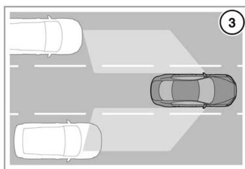
盲点监测器（BSM）系统监测车辆附近驾驶者难以看到的一个区域，该系统设计用于识别任何超越车辆的物体（3）。系统利用车辆两侧的雷达识别车辆盲点内的超车车辆 / 物体，而忽略那些静止不动或反方向行驶等的其他物体。
