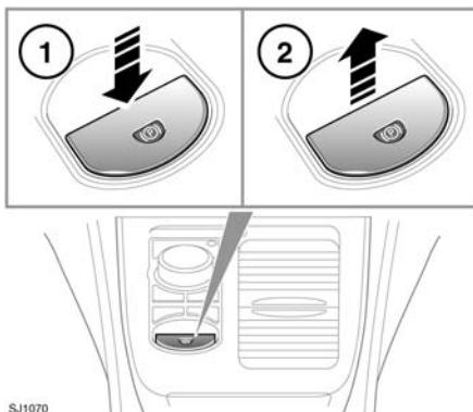
控制驻车制动器的开关安装于换档杆后边的中央控制台上。
