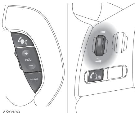
Active el control por la voz pulsando y soltando el interruptor de "Teléfono/Reconocimiento de la voz", y escuchará una señal acústica (si está activo, el sistema de sonido se silencia). La señal acústica indica que el sistema aguarda una entrada hablada.
