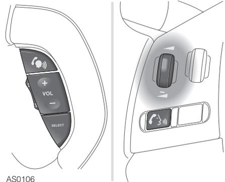
Um die Spracherkennung einzuschalten, drücken Sie den Schalter für **'Telefon/Spracherkennung'**; daraufhin wird ein Signalton abgegeben (das Audiosystem wird ggf. stummgeschaltet). Der Signalton zeigt an, dass das System jetzt auf einen Sprachbefehl wartet.
