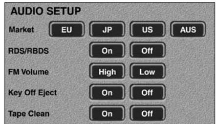
Mit Hilfe dieser Funktion kann das Radio entsprechend den eigenen Wünschen eingestellt werden. Durch die Auswahl von **SETUP** (Einstellung) und mit Hilfe der Tasten auf dem Touchscreen kann der Fahrzeugeigentümer oder der Jaguar Vertragspartner bzw. autorisierte Servicebetrieb bestimmte Radiofunktionen einstellen.
