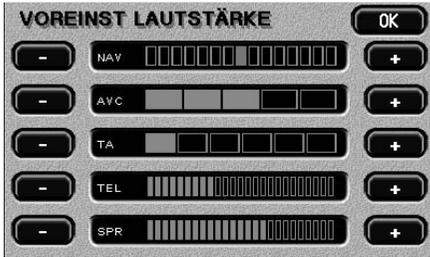
Mit dieser Funktion wird die Lautstärke immer so eingestellt, dass die Fahrgeräusche unabhängig von der jeweiligen Geschwindigkeit nicht stören können. Zum Einschalten von AVC die Taste **MENU** drücken, gefolgt von der Taste **VOREINST LAUTSTÄRKE** (Voreinstellung Lautstärke) auf dem Touchscreen. Auf dem Bildschirm für die Voreinstellung der Lautstärke kann der AVC-Pegel durch wiederholtes Drücken der Tasten „+“ bzw. „-“ neben der AVC-Lautstärkeanzeige eingestellt werden (von aus bis 5).
