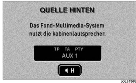
Im Beispiel oben wird AUX1 verwendet, und zur Information des Fahrers ist TP, TA oder PTY am Radio eingestellt.
