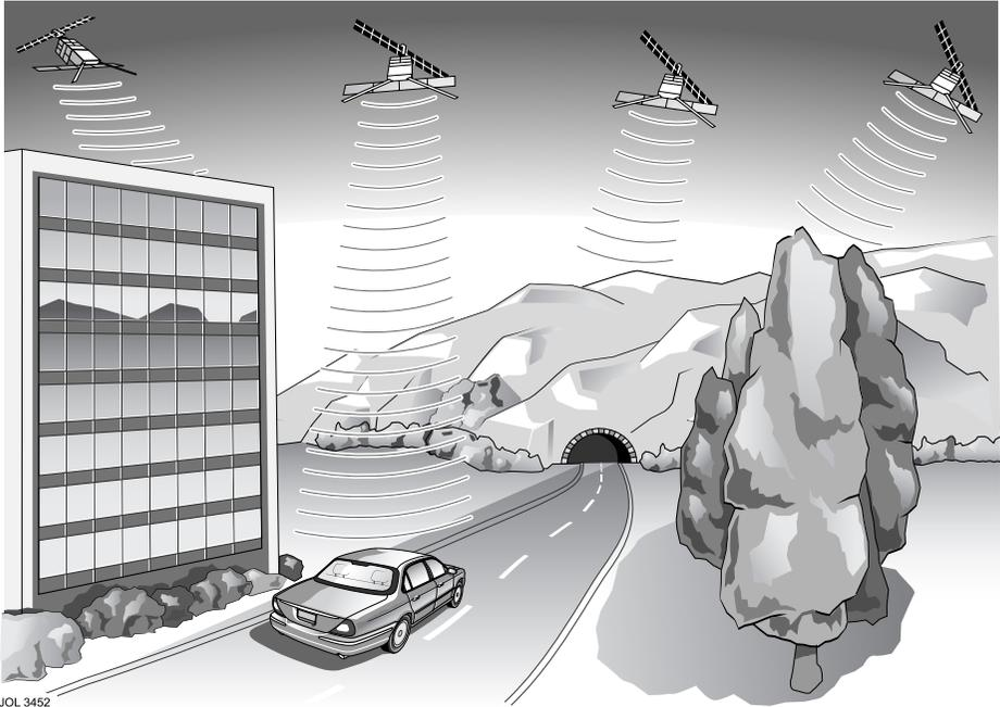
Das System empfängt und verarbeitet Signale von Satelliten des GPS-Systems (Global Positioning System), mit denen die ungefähre Fahrzeugposition berechnet werden kann. Die Ermittlung der tatsächlichen Position des Fahrzeugs erfolgt mittels der Signale der Fahrzeugsensoren und der Informationen auf der Navigationssystem-DVD.
