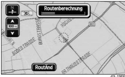
Weicht das Fahrzeug unter Zielführung von der Route ab, wird automatisch eine neue Route berechnet. Während der Neuberechnung der Route wird auf dem Bildschirm „Routenberechnung“ angezeigt; außerdem werden Zeit und Entfernung bis zum Fahrtziel durch die Luftlinienentfernung und die Fahrtrichtung zum Fahrtziel ersetzt.
