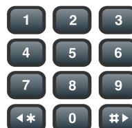
Pulse los dígitos para marcar el número de teléfono deseado. Cada tecla pulsada emitirá una señal acústica y los números irán apareciendo en el panel de mandos del sistema de audio.
