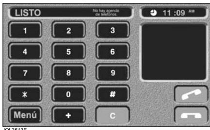
La ventana de mensajes situada en la parte derecha de la pantalla le proporcionará información referente al estado del sistema de telefonía. La pantalla indicará **Phone Connected** (Teléfono asociado) cuando el teléfono esté correctamente asociado, o **No BT Phone** (Teléfono sin tecnología Bluetooth) si el teléfono no está debidamente asociado.
