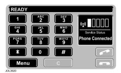
Nota: es posible que la pantalla pase momentáneamente del mensaje Discover Me (Descúbrame) al de No BT Phone (Teléfono sin tecnología Bluetooth<sup>®</sup>) mientras el sistema establece la conexión Bluetooth<sup>®</sup>, antes de que aparezca el mensaje Phone Connected (Teléfono asociado) en la pantalla.
