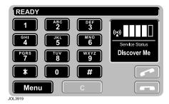
Cuando se muestra la pantalla **Discover Me** (Descúbrame), el sistema del vehículo estará a la espera de que se establezca una comunicación con un teléfono equipado con tecnología Bluetooth<sup>®</sup>.
