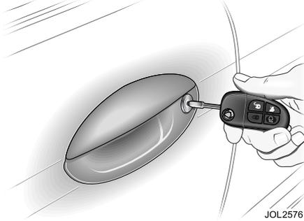
Alle Türen können entweder über die Tasten der Schlüsselfernbedienung oder mit Hilfe des integrierten Schlüssels ver- und entriegelt werden.
