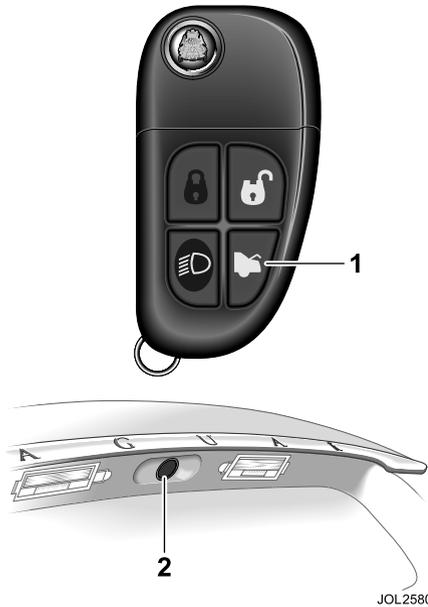
Wird der Kofferraum bei eingeschalteter Alarmanlage mit der Schlüsselfernbedienung geöffnet, wird kein Alarm ausgelöst. Nach dem Schließen des Deckels wird die Alarmanlage automatisch wieder aktiviert. Diese Wiederaktivierung findet nicht statt, wenn die Alarmanlage in der Zwischenzeit ausgeschaltet wurde.
